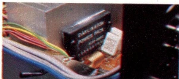
Il finale è realizzato con moduli ibridi. Il pannello posteriore è completato dalla presenza di tre prese americane d'alimentazione, dal cambiattensione e dal fusibile di rete.
